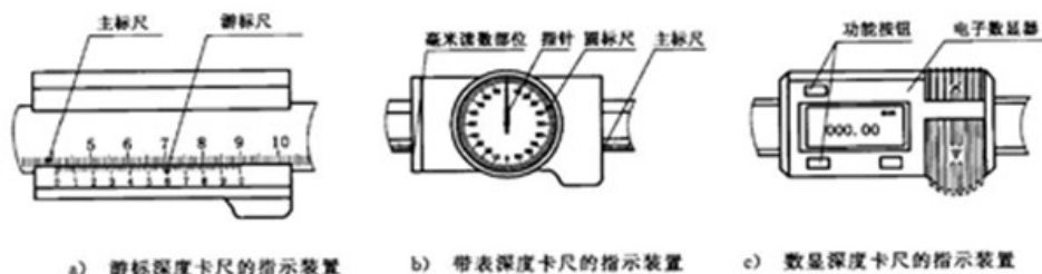
图4 深度卡尺的指示装置示意图
