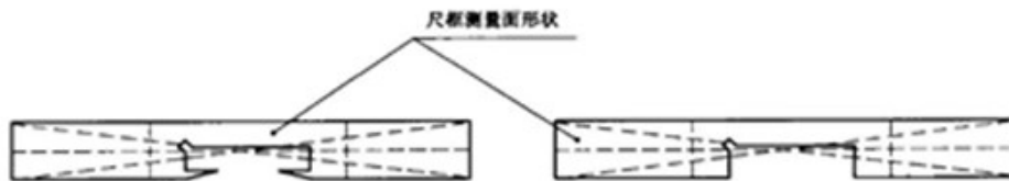
图 B.1 尺框测量面平面度的检验示意图
